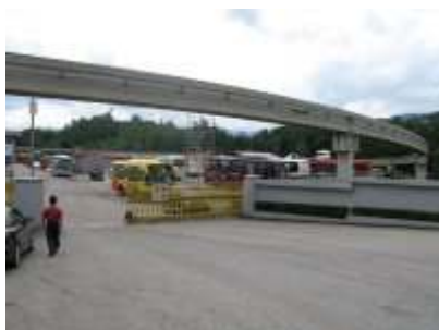
Rel untuk test unit. Dibelakang terlihat satu unit monorel di atas test-rail
