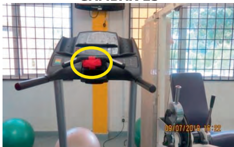
Kompleks Sukan Seremban 2 - Emergency Stop Button Telah Rosak Ditampal Dengan Tape (09.07.2019) (Sumber: Jabatan Audit Negara)
