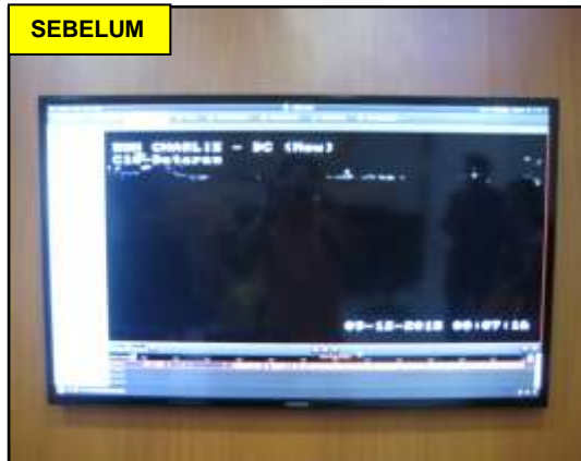
GAMBAR 4.12 Imej CCTV Yang Gelap Pada Waktu Malam Kerana Pencahayaan Tidak Mencukupi
