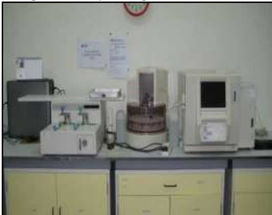
GAMBAR 5.12 Total Organic Carbon Analyzer Yang Tidak Dapat Digunakan - RM49,200
