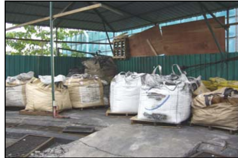
Loji Pelupusan Sisa Klinikal Kamunting - Bottom Ash Tidak Ditempatkan Di Dalam Stor Tertutup
