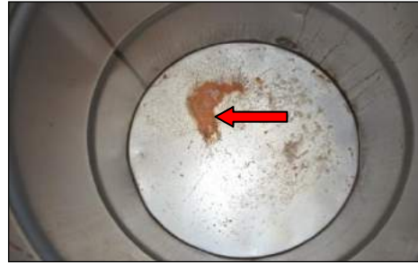
Stor Pusat, Penjara Bentong - Tong Peralatan Mengisi Diesel Yang Telah Berkarat (21.05.2013)
