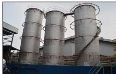
Syarikat Daya Clarimax Sdn. Bhd., Pelabuhan Klang, Selangor - Kolum Penyulingan Untuk Sisa Cecair Yang Telah Dirawat (30.08.2013)
